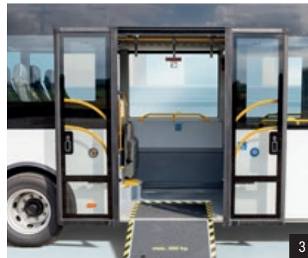
3. Rampe d'accès pour fauteuils roulants 4. Poste de conduite optimisé
