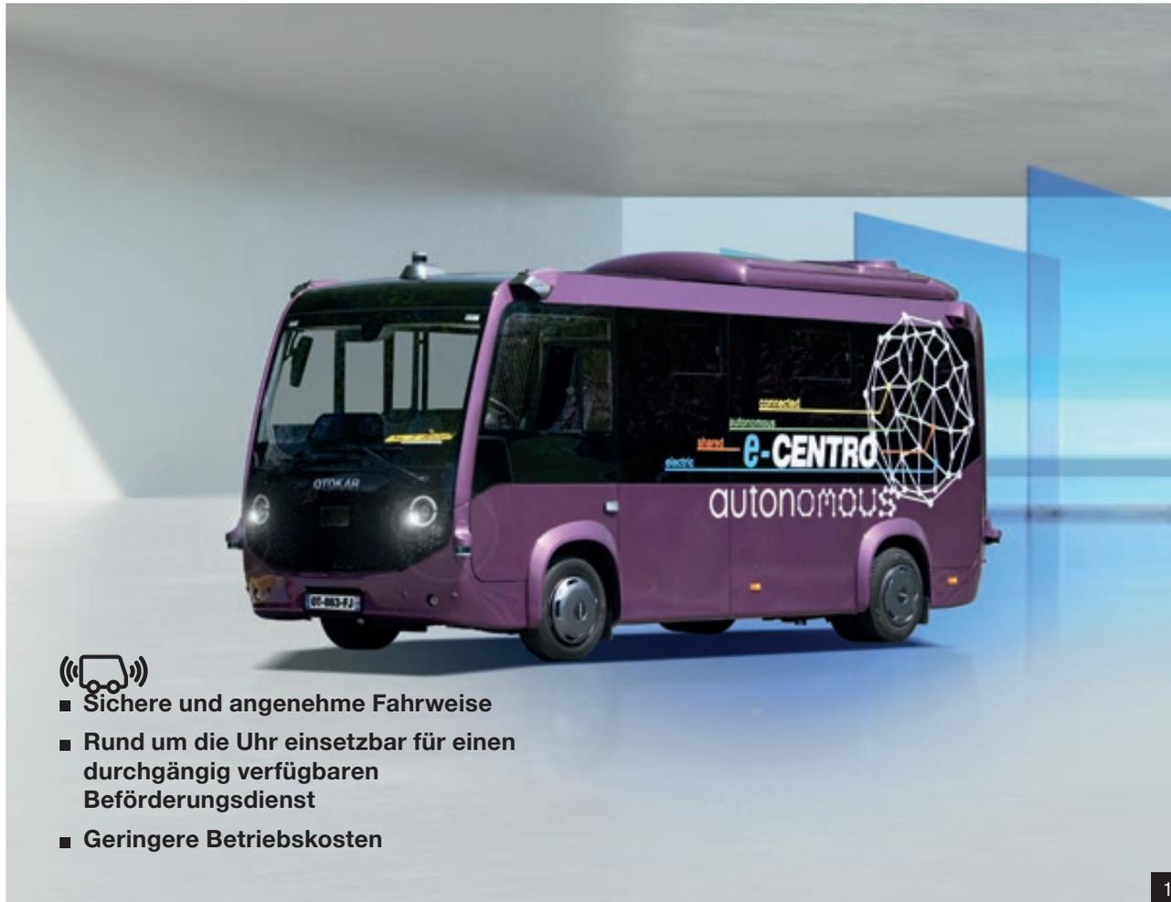
Das autonome Modell der Stufe 4 des **e-CENTRO C** kann ohne Fahrpersonal selbstständig fahren. Dabei hält es die Verkehrsregeln ein und optimiert die Strecke entsprechend den Verkehrsverhältnissen.
